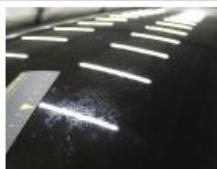
Dak, Chemische schade, LI - Herstellen en schilderen (compleet)
