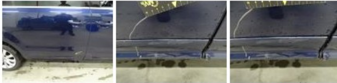
Drempel binnen A R, Deuk(en) en kras(sen), LI - Herstellen en schilderen (compleet) 115,56
