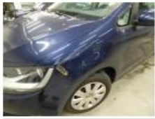
Vleugel A R, Deuk(en) en kras(sen), LI - Herstellen en schilderen (compleet)
