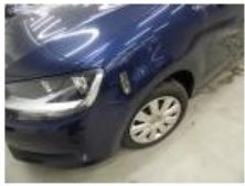
Vleugel V L, Deuk(en) en kras(sen), LI - Herstellen en schilderen (compleet)
