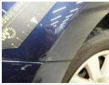
Vleugel A R, Deuk(en) en kras(sen), LI - Herstellen en schilderen (compleet)
