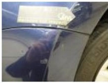
Vleugel V L, Deuk(en) en kras(sen), LI - Herstellen en schilderen (compleet)
