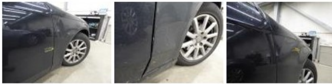
Drempel buit. R, Deuk(en), LI - Herstellen en schilderen (compleet) 310,50
