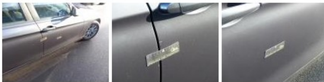
Bekleding A-wand, Kras(sen), Aanvaardbaar
