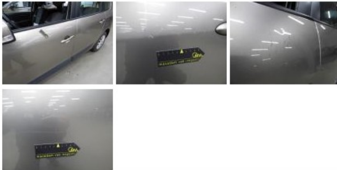
Deur A R, Deuk(en) en kras(sen), LI - Herstellen en schilderen (compleet) 318,35
