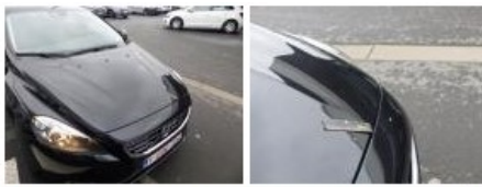
Drempel buit. L, Beschadigd, LI - Herstellen en schilderen (compleet)
