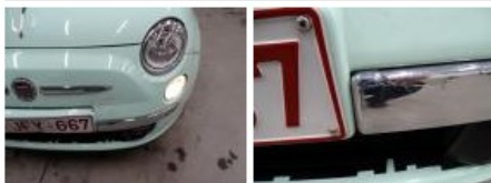
Bumperhoek V R, Beschadigd, E - Vervangen
