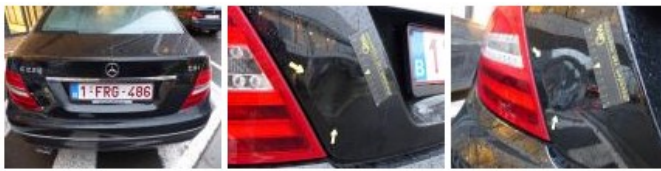
Door R R, Bump(s), Acceptable 0,00
