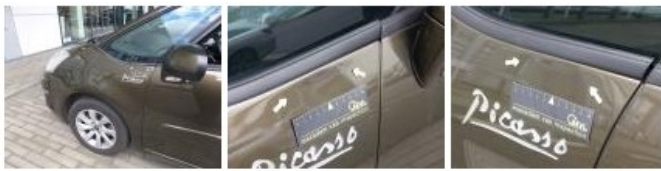
Door R R, Bump(s) and scratch(es), Acceptable 0,00
