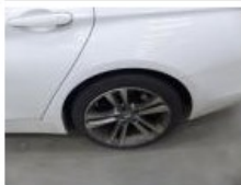
Alloy rim R L polished, Scratch(es), E - Replace
