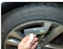
Alloy rim R L polished, Scratch(es), E - Replace
