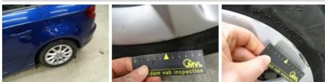
Door F R, Bump(s), Acceptable
