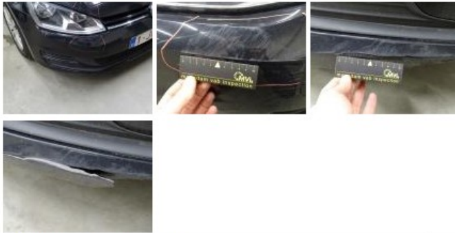
Headlight R, Scratch(es), E - Replace 396,00
