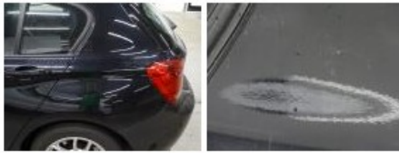
Door F R, Bad repair, Paint 0,00
