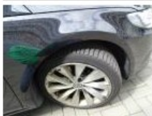
Tyre F R, Damaged, E - Replace 132,00
