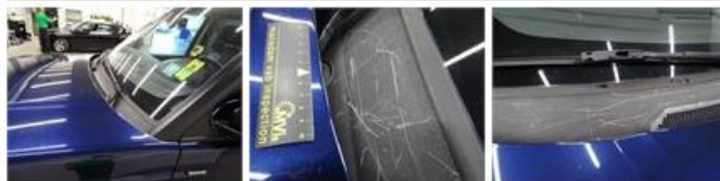
Door F R, Scratch(es), Acceptable
