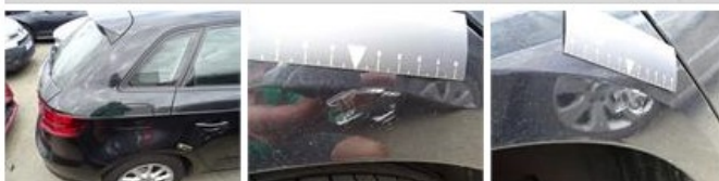
Door R R, Scratch(es), Acceptable 0,00
