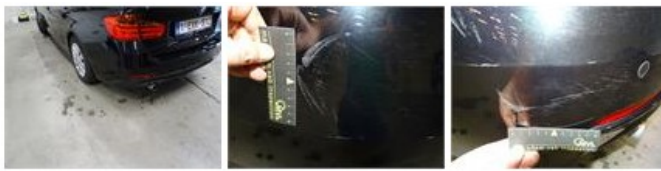
Door F R, Bad repair, Acceptable 0,00
