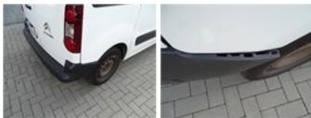
Trunk door panel R, Damaged, E - Replace
