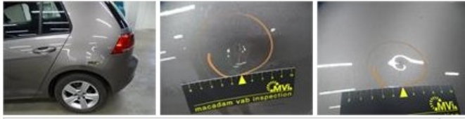
Door F R, Scratch(es), Acceptable 0,00
