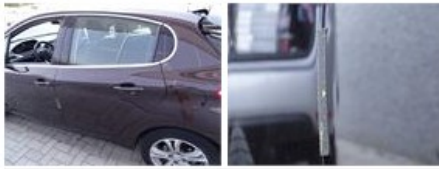
Door panel F L, Scratch(es), Acceptable 0,00
