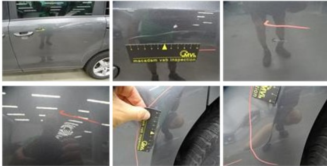
Door R R, Scratch(es), Acceptable 0,00
