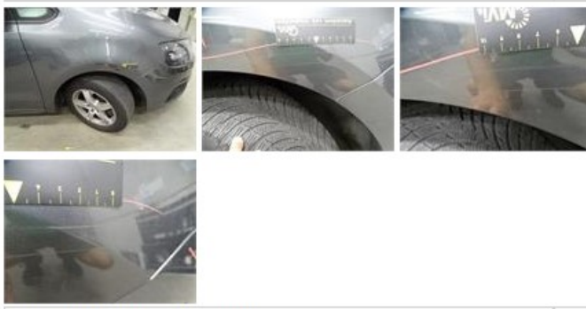
Door F R, Scratch(es), Acceptable 0,00
