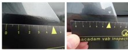
Door F R, Scratch(es), Acceptable
