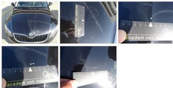
Door F R, Scratch(es), Acceptable
