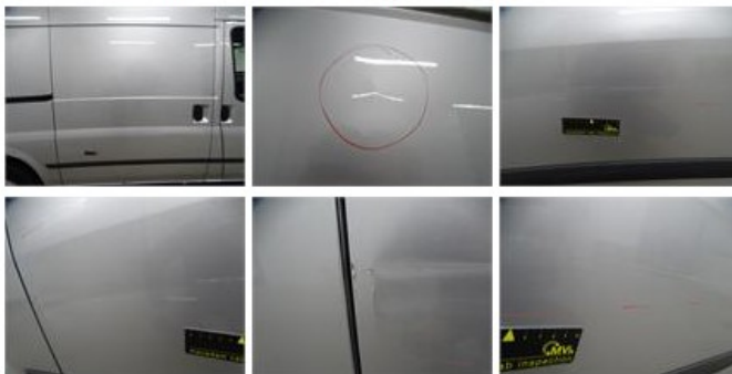
Sidewall FL (LCV), Scratch(es), Acceptable 0,00
