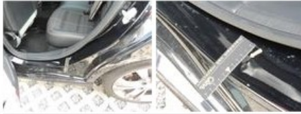
Door F R, Scratch(es), Acceptable
