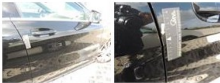
Door panel R R, Hole, E - Replace
