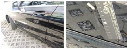
Door R L, Repaired, P - Check
