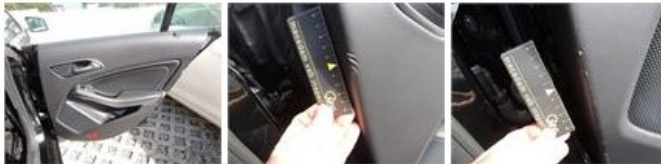
Door panel R R, Hole, E - Replace
