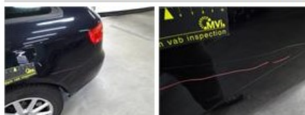
Door R R, Scratch(es), Acceptable
