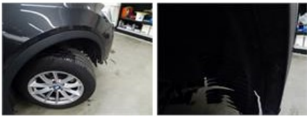
Door moulding Lower R R, Scratch(es), E - Replace
