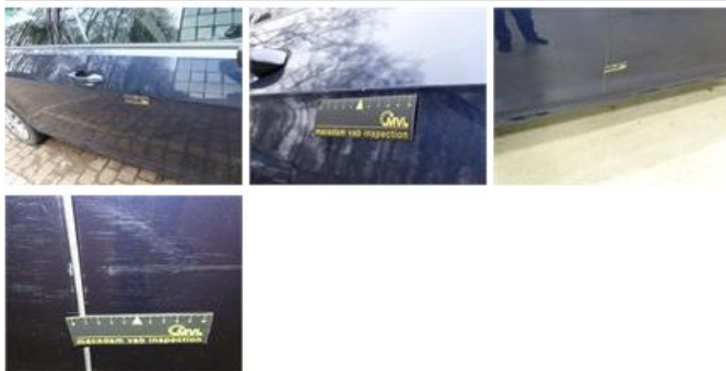
Door F R, Scratch(es), Acceptable 0,00
