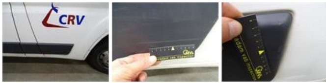
Door moulding Lower F R, Scratch(es), E - Replace
