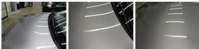
Door R R, Scratch(es), Acceptable
