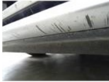
Door R R, Scratch(es), Acceptable
