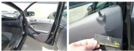
Door panel R R, Tear, E - Replace
