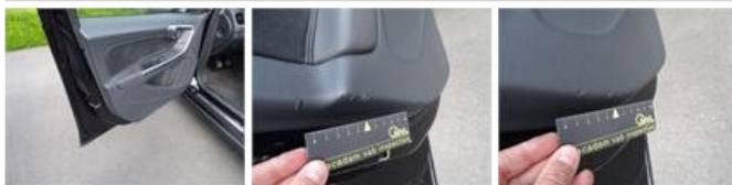
Door R R, Scratch(es), Acceptable
