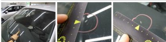
Door F R, Scratch(es), Acceptable
