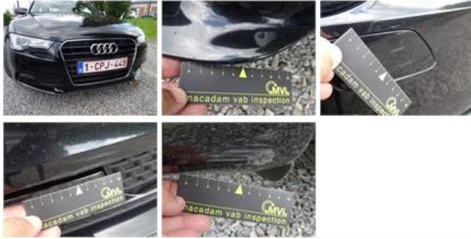
Door F R, Scratch(es), Acceptable
