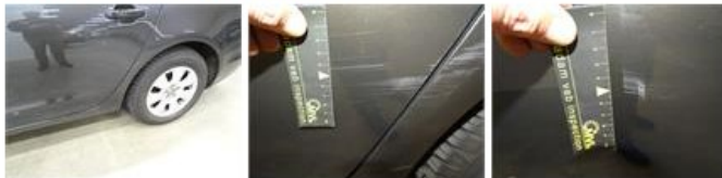
Door F R, Scratch(es), Acceptable
