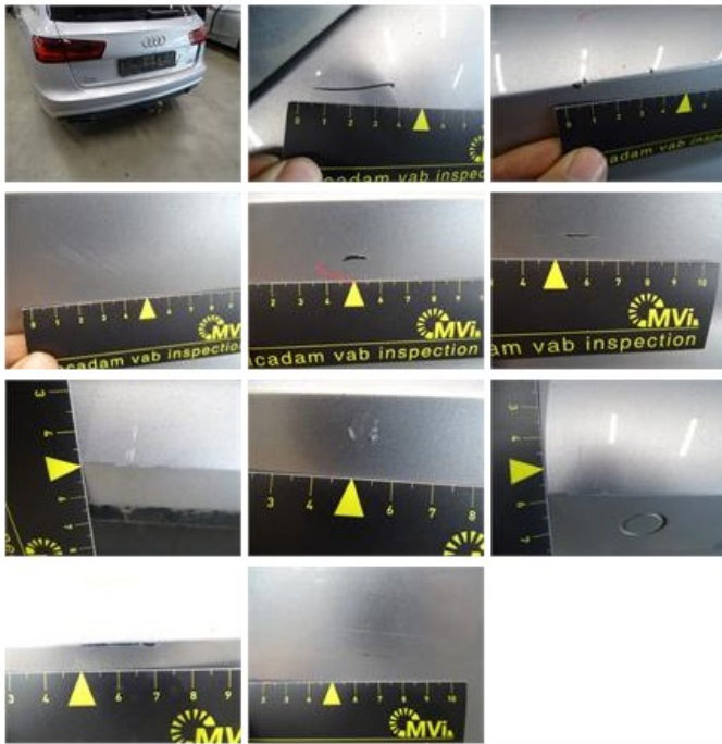
Door R R, Scratch(es), Acceptable
