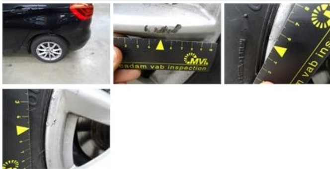
Door R R, Scratch(es), Acceptable
