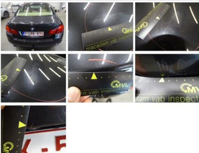
Door R R, Scratch(es), Acceptable 0,00
