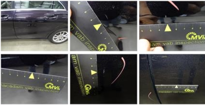
Door panel R L, Tear, E - Replace
