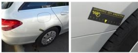
Door R R, Scratch(es), Acceptable
