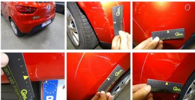
Door R R, Scratch(es), Acceptable 0,00
