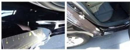
Door R R, Scratch(es), Acceptable
