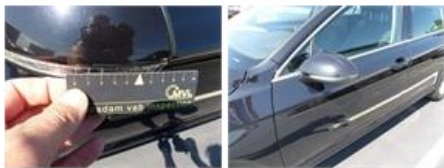
Door F L, Repaired, Acceptable
