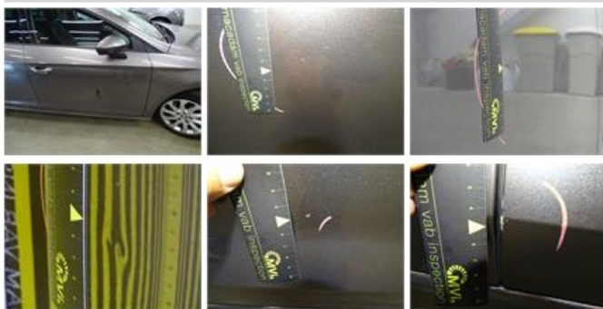
Door R R, Scratch(es), Acceptable
