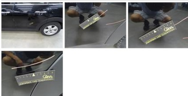
Door trim R R, Scratch(es), E - Replace
