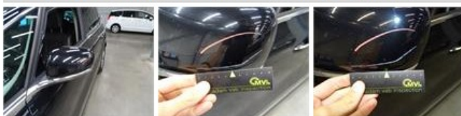
Door R R, Scratch(es), Acceptable
