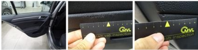
Door F R, Scratch(es), Acceptable
