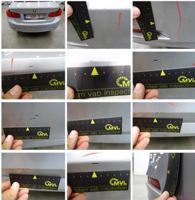
Door R R, Scratch(es), Acceptable
