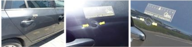
Door panel F L, Tear, E - Replace
